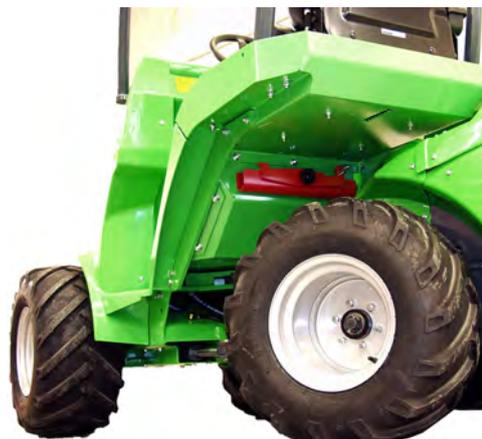
Cette barre de verrouillage est prévue pour verrouiller le châssis articulé afin de permettre que le châssis de chargeur reste droit lors par exemple, du levage ou du transport.
