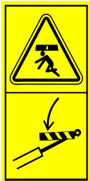
**Chute de la charge - Risque d'écrasement.** Protégez toujours le bras de levage du chargeur à l'aide du support de service prévu avant d'aller sous le bras de levage du chargeur. Retirez toute charge et tous accessoires du chargeur avant de procéder à l'entretien ou à la maintenance.
