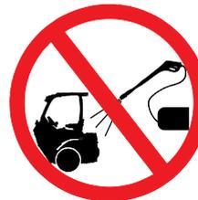
**Risque d'endommagement de la batterie et du déversement d'acide - N'utilisez jamais une laveuse à pression pour nettoyer la batterie.** La laveuse à pression peut endommager les cellules de batterie ou les bouchons au dessus de celle-ci, ce qui favorisera l'entrée de l'eau dans la batterie. Ceci résultera en l'endommagement de la batterie et peut aussi favoriser l'écoulement de l'électrolyte (acide) de la batterie. Nettoyez la batterie d'après les instructions de ce manuel de l'opérateur.
